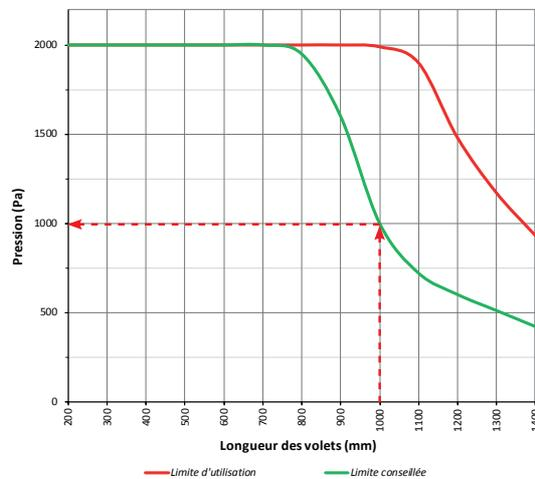
Nous recommandons de ne pas dépasser une pression différentielle de 1000 Pa pour un registre U d'une longueur de 1000 mm.
