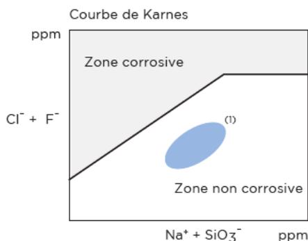
Remarque : les analyses chimiques des ions réalisées conformément aux normes ASTM C-795 et C-871 montrent que les produits en laine de roche ISOVER ne génèrent pas la corrosion de l'acier car la relation des ions Cl<sup>-</sup> + F<sup>-</sup> par rapport aux ions Na<sup>+</sup> + SiO<sub>3</sub><sup>-</sup> se situe dans la partie inférieure de la Courbe de Karnes.
