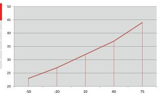
Épaisseurs recommandées pour réseau eau froide à 7°C et ambiance à 26°C avec convection 1 m/s selon normes NF ISO12 241
