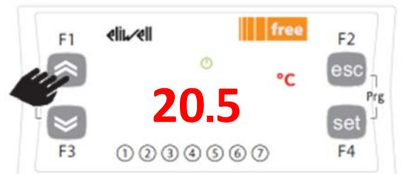
En plus de la température de consigne, le programme permet de régler la pente selon laquelle la régulation va fonctionner. Cette pente est définie par le paramètre « **dfH** ».
