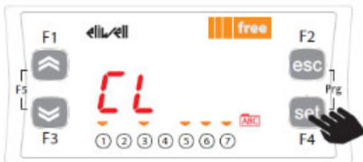
Appuyer sur « set » (F4) pour entrer dans les paramètres de l'automate. Faire défiler les menus en utilisant les flèches haut et bas (F1 et F3) jusqu'à atteindre **CL**. Appuyer sur set (F4) pour accéder aux réglages de dates et d'heures.
