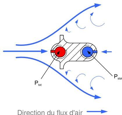
La mesure est effectuée à plusieurs points de mesure à l'intérieur de la sonde. Le nombre de points de mesure dépend de la taille et de la forme du conduit. L'IML peut déterminer le débit d'air massique moyen sur base des mesures. La forme du profil de mesure permet d'effectuer des mesures précises à partir de vitesses d'air de 1,0 m/s.
