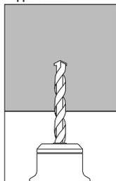
Percer le support béton à Ø5x70 mm
