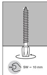
Visser à l'aide d'une clé ou douille SW = 10 mm
