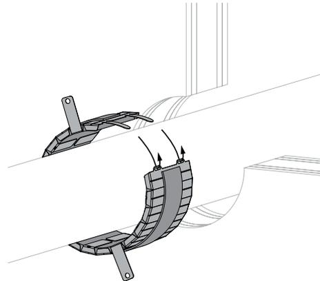
4. Pliez le manchon et montez-le autour du tuyau. Insérez les languettes de fermeture dans les ouvertures prévues. Repliez les languettes.
