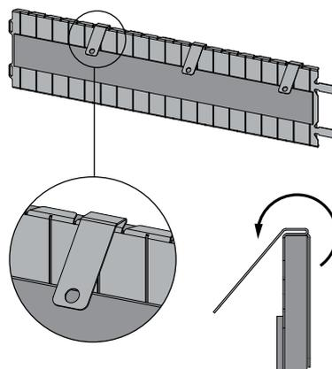
2. Pliez que les plaques métalliques avec trous pré-perçés à  $30^\circ$ .
