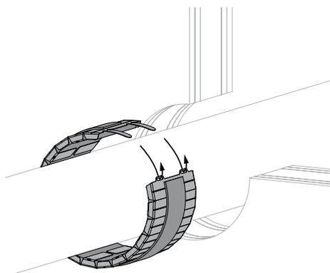
3. Pliez le manchon et montez-le autour du tuyau. Insérez les languettes de fermeture dans les ouvertures prévues. Repliez les languettes.
