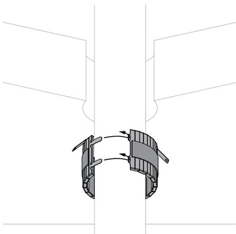
3. Pliez le manchon et montez-le autour du tuyau. Insérez les languettes de fermeture dans les ouvertures prévues. Repliez les languettes.
