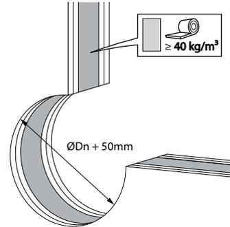
2. Prévoyez une ouverture de  $\text{ØDn} + 27$  mm minimum et  $\text{ØDn} + 50$  mm maximum pour diamètres de tuyau 32-75,  $\text{ØDn} + 36$  mm et  $\text{ØDn} + 50$  mm pour diamètres de tuyau 80-110,  $\text{ØDn} + 40$  mm et  $\text{ØDn} + 50$  mm pour diamètres de tuyau 125-160.
