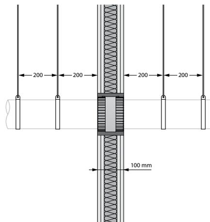
6. Attention : Cette installation n'est pas valable pour les parois flexibles d'une largeur supérieure à 100 mm (par exemple 125 ou 150 mm). Le MG-U L125/L150 est utilisé pour cela. Veuillez contacter Rf-t pour plus d'informations.
