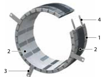
Le manchon coupe-feu MG-U convient pour installation autour des tuyaux en plastique ventilés et non ventilés (PVC, HDPE, PP, ABS, SAN+PVC). Il est encastré dans une paroi ou une dalle, et empêche la propagation du feu jusqu'à 120 minutes.
