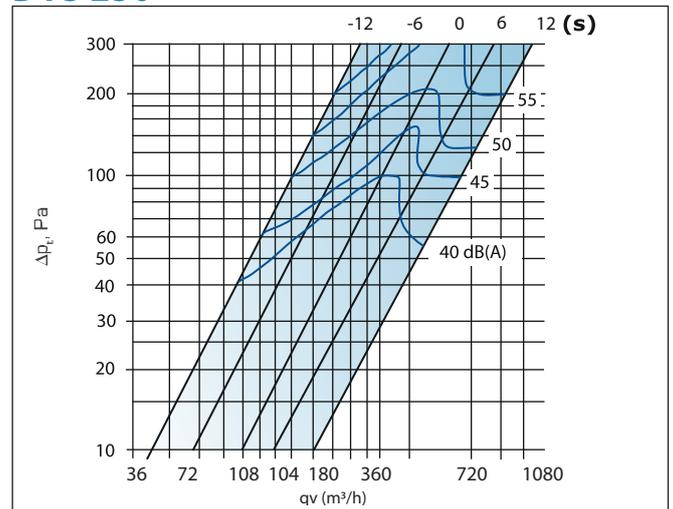
Q = Débit en  $m^3/h$  -  $\Delta P_t$  = Perte de charge en Pa -  $L_{p10A}$  = Pression sonore en dB(A) - S = Ouverture en mm
