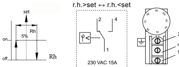
Le contact entre les bornes 1 et 2 se ferme quand l'humidité relative descend en dessous du point de consigne.
