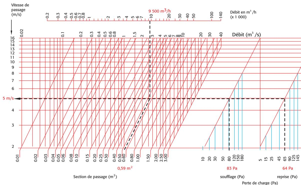
Exemple pour section de passage de 0,59 m<sup>2</sup> et débit de 9 500 m<sup>3</sup>/h.
