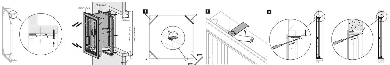
Faites une baie aux dimensions (L+A) x (H+A) mm. A = 2 x épaisseur manchon (e) +20 mm.
