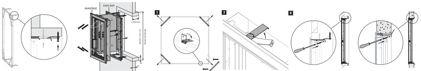
Faites une baie aux dimensions (L+A) x (H+A) mm. A = 2 x épaisseur manchon (e) +20 mm.
