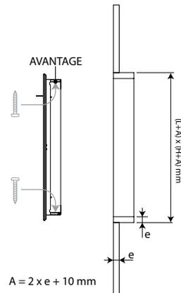
Faites une baie aux dimensions (L+A) x (H+A) mm.  $A = 2 \times \text{épaisseur manchon (e)} + 10 \text{ mm}$ .
