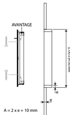
Faites une baie aux dimensions (L+A) x (H+A) mm. A = 2 x épaisseur manchon (e) + 10 mm.
